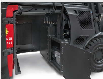
Einfacher Servicezugriff auf druckfeste Gehäuse
