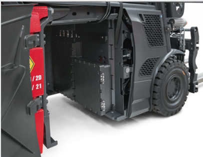
Vollständig integrierte Explosionsschutzmaßnahmen erhalten die optimalen Sichtverhältnisse und den hohen Arbeitskomfort
